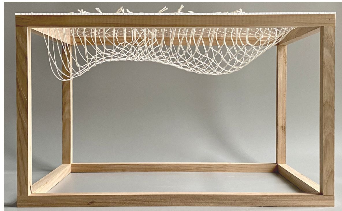
Maquette exploration structurale avec cordes sous la gravité
