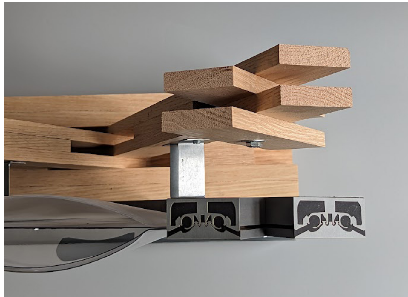
Maquettes démontrant l'assemblage des membrures
