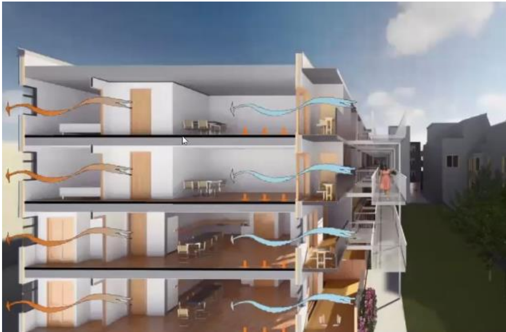
Figure 4. Schéma de ventilation naturelle traversante
